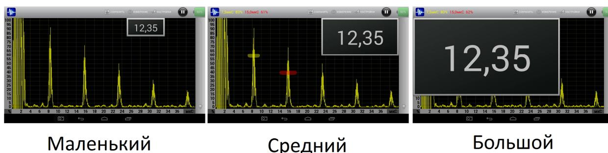
Рис. 3. Варианты отображения окна с измеряемой толщиной
