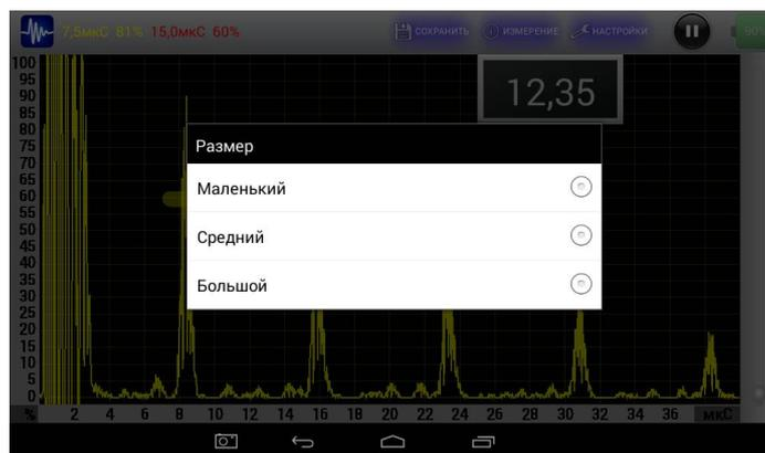
Рис. 2. Выбор размера окна с измеряемой толщиной
