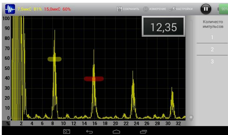
Рис. 12. Выбор количества импульсов в пакке зондирующего сигнала
