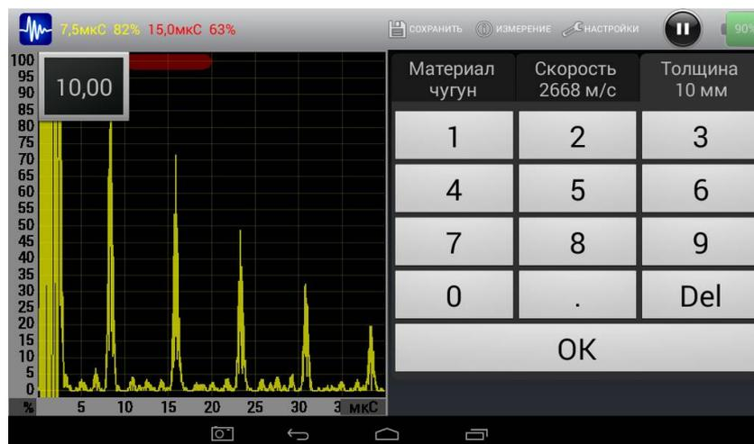
Рис. 20. Калибровка с заданием известной толщины объекта контроля
