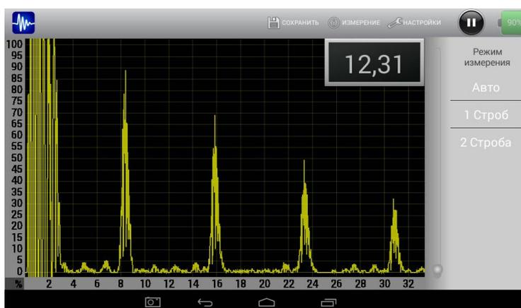
Рис. 7. Выбор режима измерения толщины
