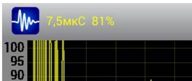
Рис. 8. Отображение координат найденного максимума в строге
