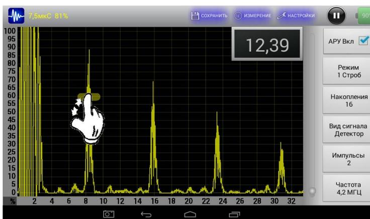
Рис. 8. Работа со стробом
